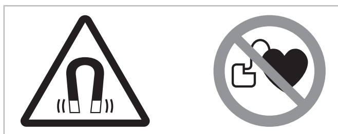
Рис. 8: Предупреждающие и запрещающие знаки на компрессоре с мотором с постоянными магнитами
