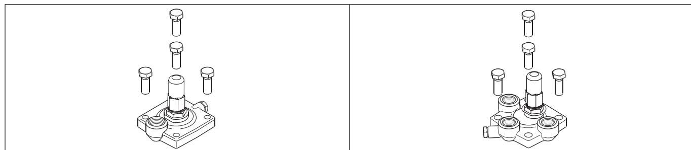
**Конструкция клапанов ICS
